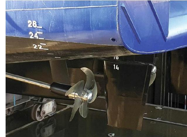
Die „Uthörn“ ist damit das erste in Deutschland gebaute Schiff, dessen Propeller mit Wasserhydraulik zu verstellen sind
